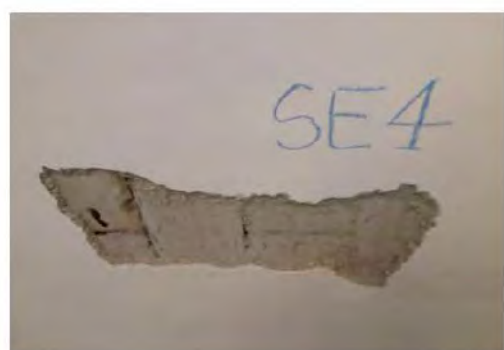
Saggi intradosso solai in latero-cemento
